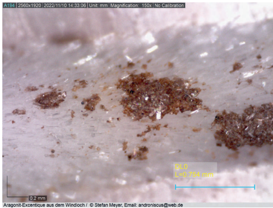
Abb. 28 Aufnahme der Partikel in und auf der geschuppten Struktur der Excentriques-Form B, (DinoLite AM 73115 MZT/Digital-Mikroskop).
