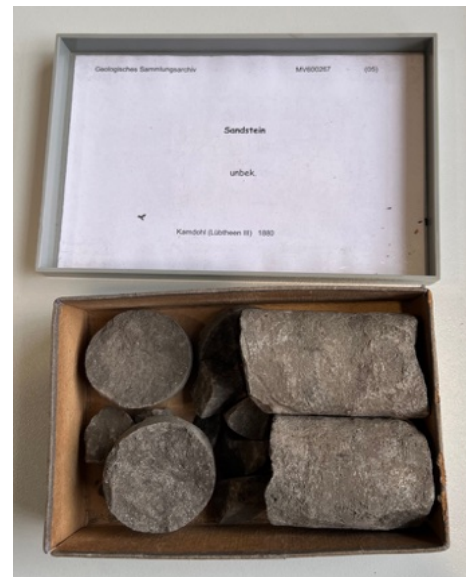
Ein historischer Bohrkern aus dem Salzstock Lübtheen. 1880 wurde eine der Bohrungen durch den Überhang des Salzstockes gebohrt und hatte darunter Sandstein des Keupers angetroffen.
