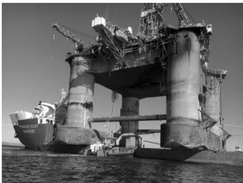
Abb. 3: Abtransport des gestrandeten Halbtauchers Transocean Winner, 2016. Die Beule im Schwimmer unten rechts ist der einzige sichtbare Schaden der Strandung.
